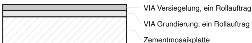
Systemaufbau der Versiegelung
